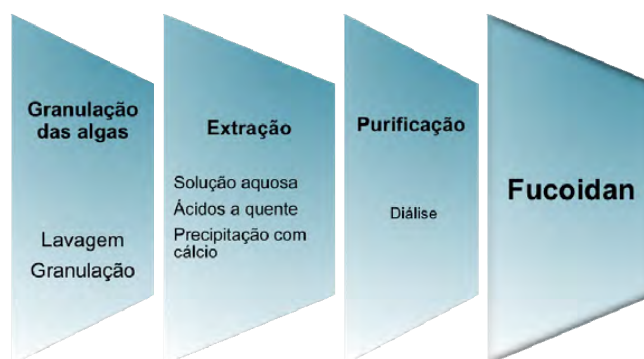
Figura 4. Esquema de extração da fucoídana.
