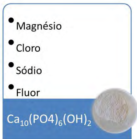
Figura 1. Alguns dos elementos existentes como componentes menores na estrutura de HA que podem influenciar a sua biocompatibilidade. A imagem corresponde ao pó de HA obtida de espinhas de sardinha por calcinação (cedido por Piccirillo e col., 2013c).
